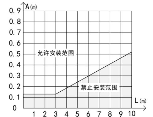
图 9-7 反射物对光栅产生影响的安装位置坐标图
