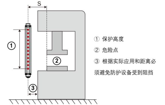
图 9-1 垂直保护区域时的安全距离示意图
