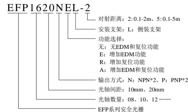
图 4-1 光栅型号说明示意图
