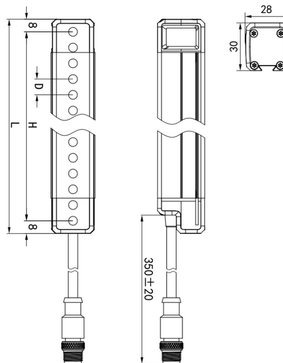
图 5-1 光栅结构尺寸示意图
