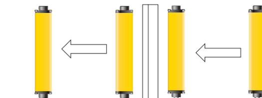
4、发射器同向时, 应在中间增加隔板
