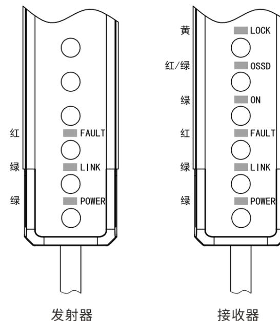
图 6-1 光栅指示灯示意图
