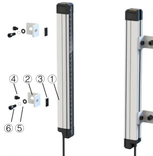
图 8-1 L 支架安装示意图
